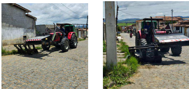
Imagem 5: Máquina realizando a Capina Elétrica
